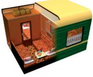
Compartiment avec 2 lits bas ( $70 \times 190 \text{ cm}$ ), une tablette, un petit espace pour les bagages au-dessous du lit et un autre, plus vaste, au-dessus de la porte.
